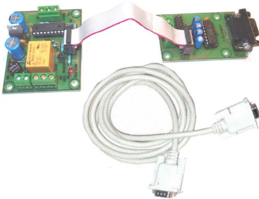
El modulo REFLEX es una tarjeta que tiene una entrada digital, una salida con relevador y un puerto de comunicaciones UART. Una interfase RS232 permite al modulo REFLEX la comunicación con una computadora personal vía puerto serie.
