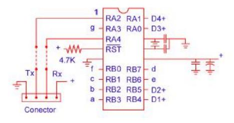
En este caso usaremos el módulo para realizar un contador de pulsos, con botón de restablecer. **La terminal Tx** estará destinada a contar los pulsos de entrada (frentes negativos),y **la terminal Rx** estará destinada a conectarse a un botón para restablecer el contador.
